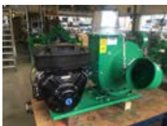
Transportrad 8-flügelig aus HB 400 Spezialstahl
