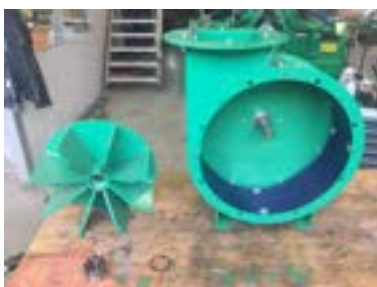
Transportrad 8-flügelig aus HB 400 Spezialstahl
