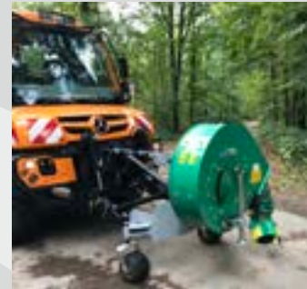
BT 600 Front-Anbau am Unimog, mit 360° drehbarem Bogen
