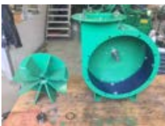
Transportrad 8-flügelig aus HB 400 Spezialstahl
