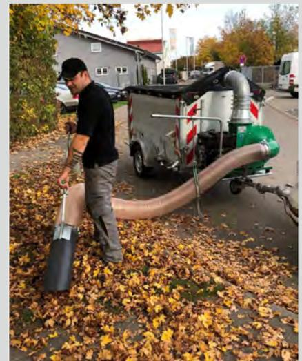
Sonderlösungen mit dem S400 motorbetrieben auf einem vorhandenen PKW-Anhänger mit Saugschlauchablage und verstellbarer Auswurfklappe
