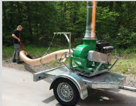
Verladegebläse S400 auf einem 80 km/h Fahrgestell über Silentblöcke montiert. Auf Wunsch mit Drehkranz versehen um immer den optimalen Ansaugwinkel zu bekommen. Ausblasbogen drehbar oder direkte Rohrüberleitung zum Aufnahmebehälter sind lieferbar. Fahrgestell komplett verzinkt und für StvZO vorbereitet.
