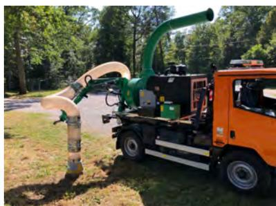
Der Saugarm kann über die hydraulische Steuerung ohne Weiteres über Zäune oder in höhere Sammelbehälter hinein gesteuert werden.
