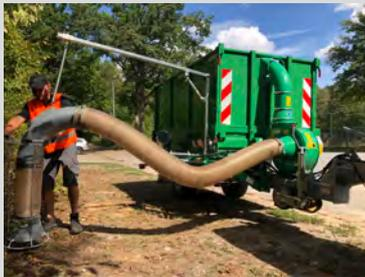
Handgeführter Saugschlauch mit Aufnahmelanze oder federentlastetes Saugrohr für eine leichte und arbeitsschutzgerechte Führung des Saugschlauches
