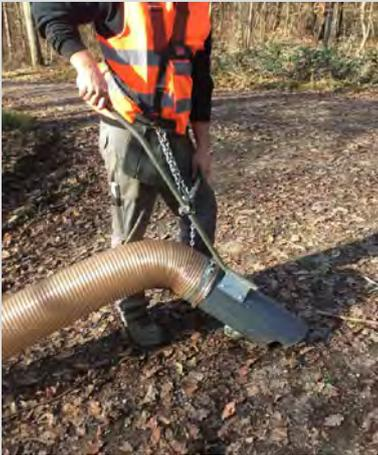
Handgeführter Saugschlauch mit Aufnahmelanze
