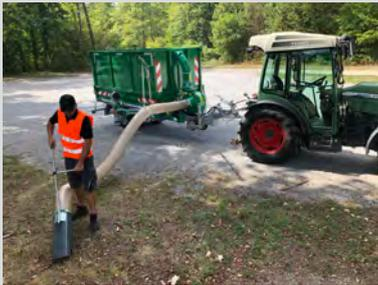
Handgeführter Saugschlauch mit Aufnahmelanze
