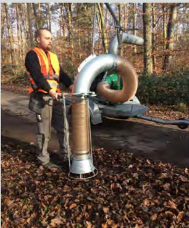
Handgeführter Saugschlauch mit Aufnahmelanze oder federentlastetes Saugrohr für eine leichte und arbeitsschutzgerechte Führung des Saugschlauches
