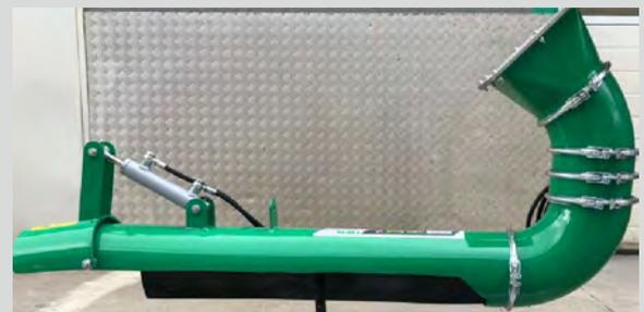
Wegetunnel mit hydraulischer Verstellklappe
