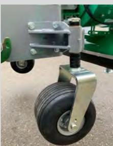
Ballonräder 360° drehbar an allen Blasgeräten
