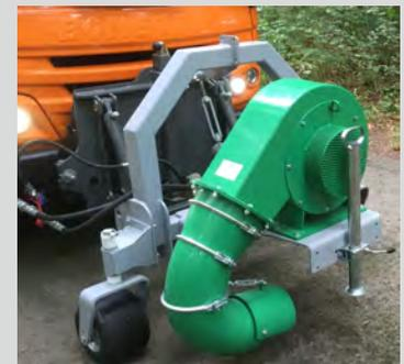
**Stabile Konstruktion mit Rohrsegmenten und Ballon Pendelräder 360° drehbar - Front und Heckvariante lieferbar**
