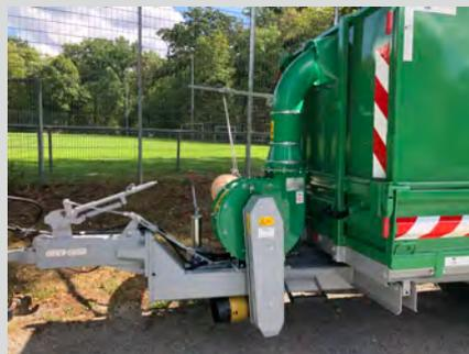
Antrieb über Zapfwelle für eine extrem hohe Saugleistung
