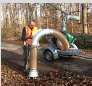
Handsaugschlauch mit Federentlastung
