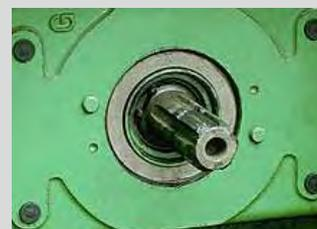
✓ Mechanischer Antrieb über die Zapfwelle des Trägerfahrzeuges
