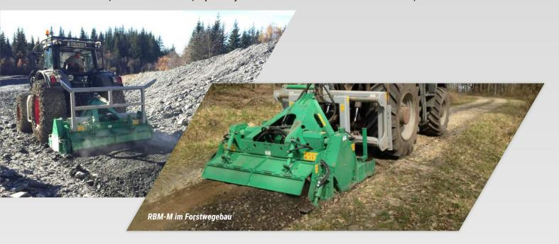
Gewachsene Felsspitzen oder Asphaltbeläge abfräsen und in einbaufähiges Wegebaumaterial Sieblinie 0-45 mm herstellen.
