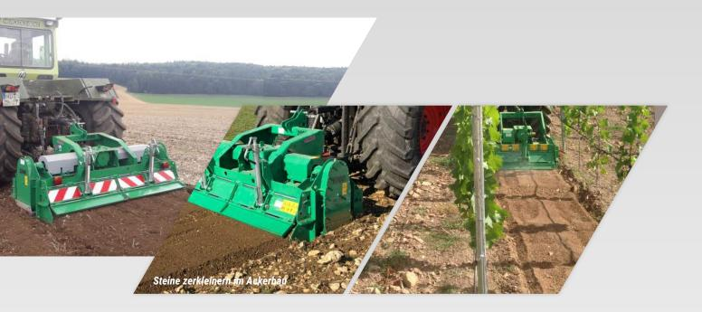
Extrem niedrige Rotordrehzahl durch im Ölbad laufende Stirnradgetriebe für geringere Bodenverdichtung der Frässohle im Ackerbau.
