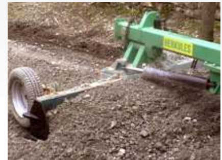
Großes, höhenverstellbares Gummilauftrad, mitlenkend
